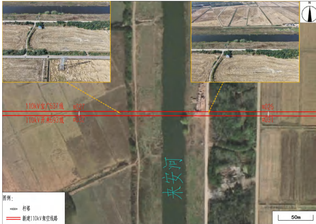
图 2-1 线路沿线跨越水体情况
