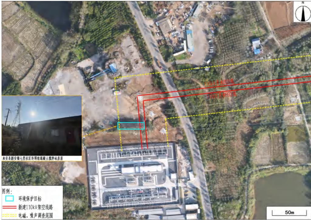
线路敏感点 6: 来安县新安镇七里社区许郢组混凝土搅拌站房屋
